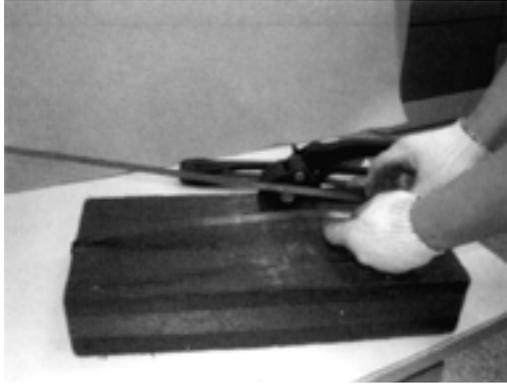
**1.** Placez le feillard autour de l'objet à sécuriser tel qu'indiqué. L'extrémité du feillard est en dessous
